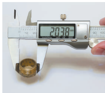
Рис. 2.3. Штангенциркуль. Точність вимірювання зображеним приладом — соті частки міліметра
