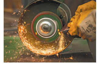
Рис. 8.2. Швидкості руху іскор феєрверка, бризок з-під коліс автомобіля, металевих ошукрок напрямлені по дотичній до кола. Саме в цьому напрямку частинки продовжують свій рух після відриву
