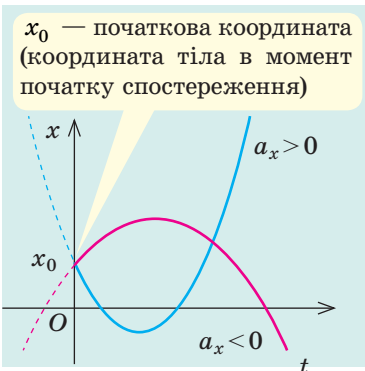
Рис. 6.6. У разі рівноприскореного прямолінійного руху графік залежності x(t) — парабола
