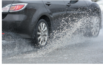
Рис. 8.2. Швидкості руху іскор феєрверка, бризок з-під коліс автомобіля, металевих ошукрок напрямлені по дотичній до кола. Саме в цьому напрямку частинки продовжують свій рух після відриву
