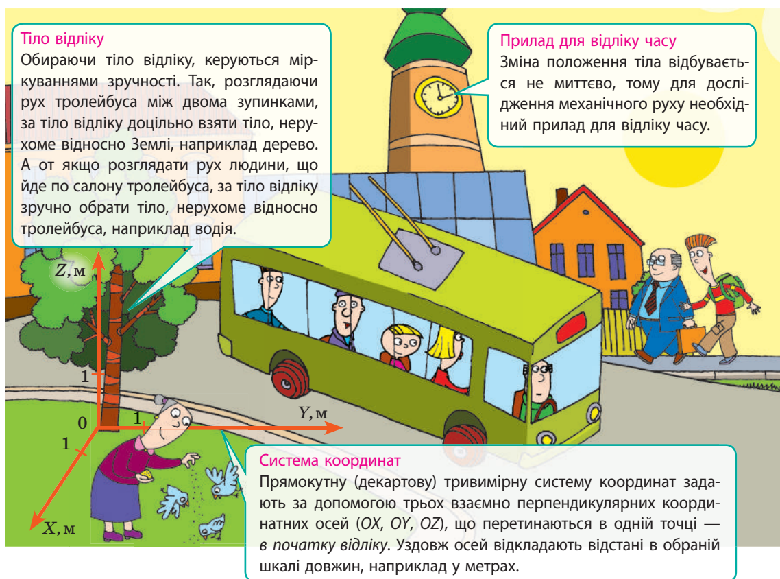
Рис. 4.2. Складники системи відліку: тіло відліку, система координат, прилад для відліку часу
