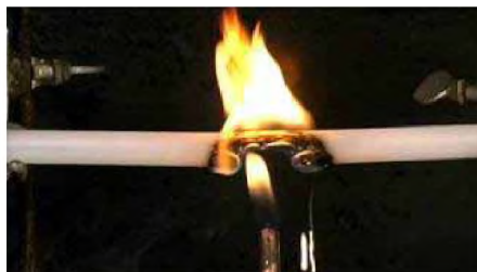
Мал. 46 Згорання поліетиленового виробу
