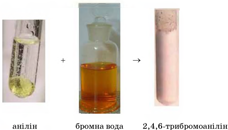
Мал. 35 Ілюстрація взаємодії аніліну з бромною водою
