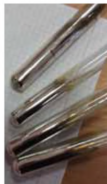
Мал. 31 Посрібнення пробірок унаслідок проведеної в них реакції «срібного дзеркала»
