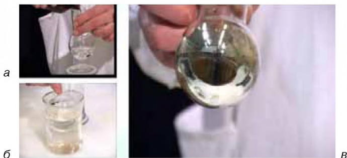
Мал. 24 Реакція «срібного дзеркала»: а, б — проведення; в — посріблена колба
