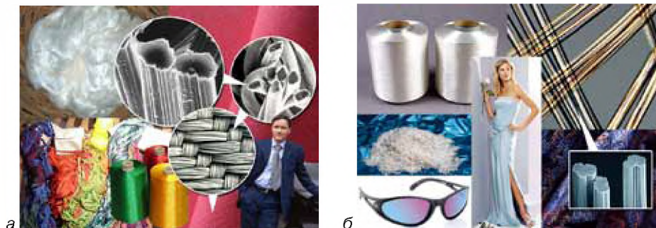
Мал. 55 Штучні волокна (а — віскозне; б — ацетатне) та вироби з них
