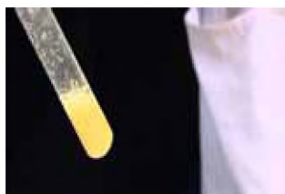
Мал. 42 Результат ксантопротеїнової реакції
